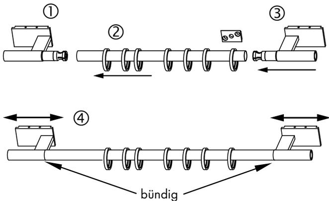
1. Einen Träger an die Wand montieren ① (beweglich lassen)
