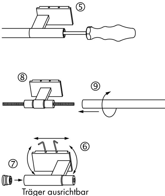
1. Zwischenträger an die Wand montieren ⑧ (beweglich lassen)
